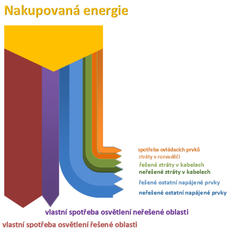
Obrázek 2 – Sankyho diagram toku energií v případě řešení projektu pouze části SVO
